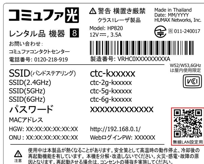
スマートフォンでカメラアプリを開き、QR コードをスキャンすることで SSID (バンドステアリング) に自動的に接続されます。
